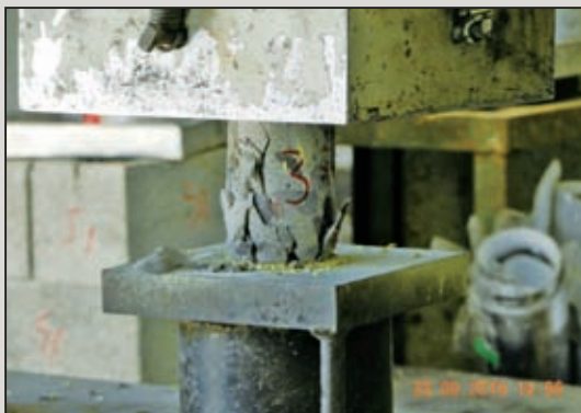
圖16 鑽心取樣後進行混凝土抗壓強度試驗
