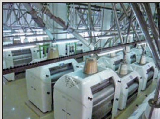
圖8 研磨廠內小麥磨粉機磨成初胚麵粉
