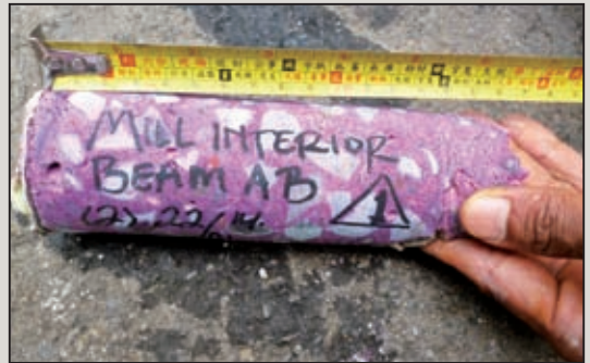
圖17 鑽心取樣後進行混凝土中性化檢測作業
