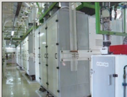
圖9 研磨廠內平面篩選機進行麵粉顆粒篩選檢驗
