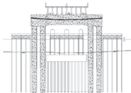
圖14 台61線中彰大橋換底工法施工步驟
