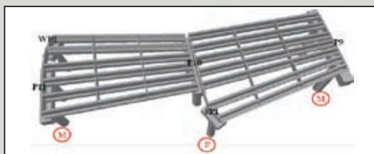
圖5 關渡橋引橋P9~P11結構系統
