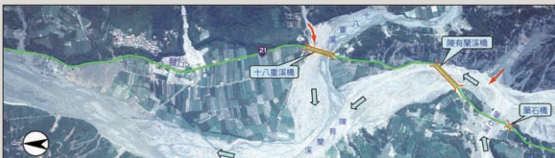
圖12 土石流造成台21線橋梁災害(2001年桃芝颱風)
