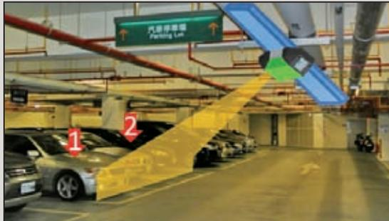
圖3 車位在席偵測系統顯示示意圖
