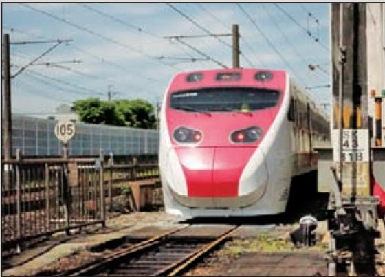
車體傾斜適當角度，減少離心力，以提高行車速度，其最高設計速度可達150km/hr以上[1]。
