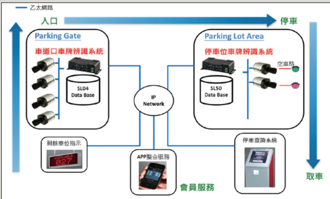
圖7 車位在席偵測與尋車系統之系統架構圖
