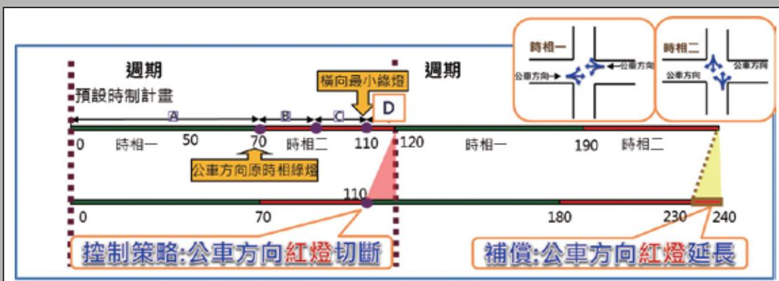
圖5d 公車於D時段到達路口控制邏輯圖(二時相)
