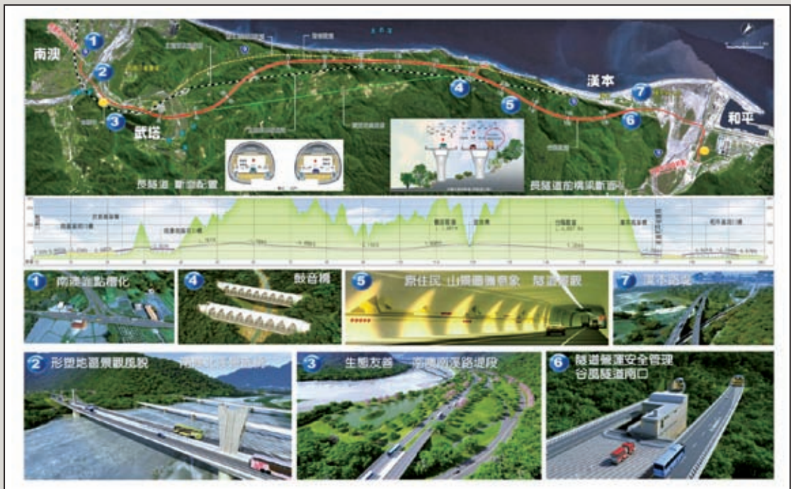
圖6 南澳和平段平縱面配置示意 (公路總局蘇花公路改善工程處提供)
