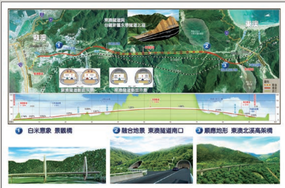
圖5 蘇澳東澳段平縱面配置示意 (公路總局蘇花公路改善工程處及中興工程顧問公司提供)
