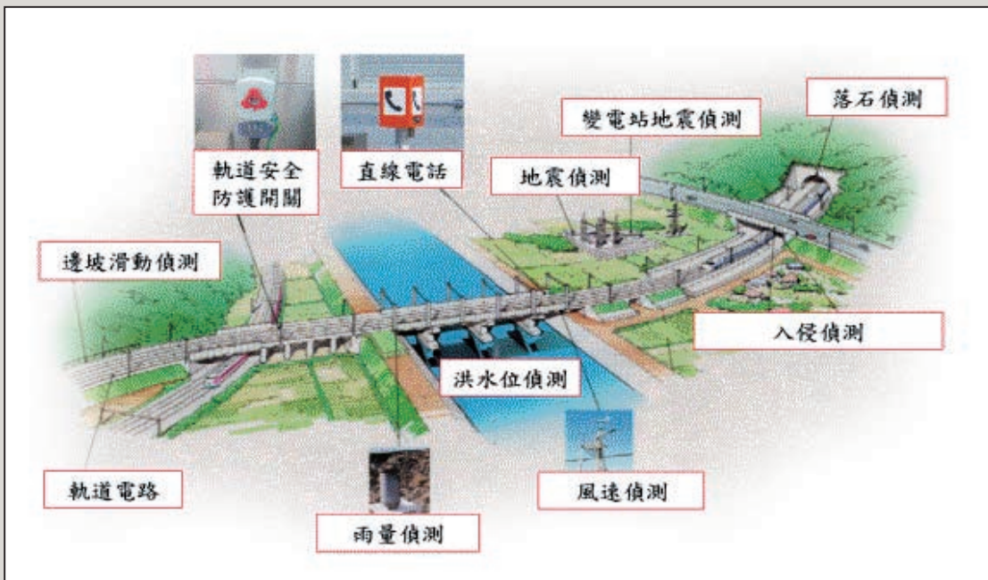
圖13 高鐵天然災害偵測與預警系統安裝示意圖
