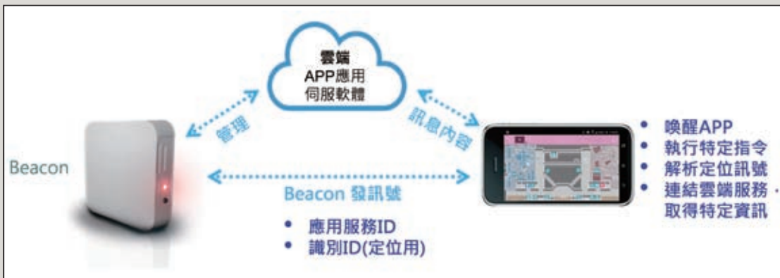
圖5 信號柱運作架構示意圖
