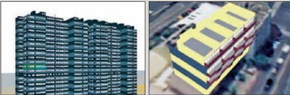
圖18 運用地籍建物測量成果產生之LOD3建物模型(引用江渾欽、馮怡婕[3])
