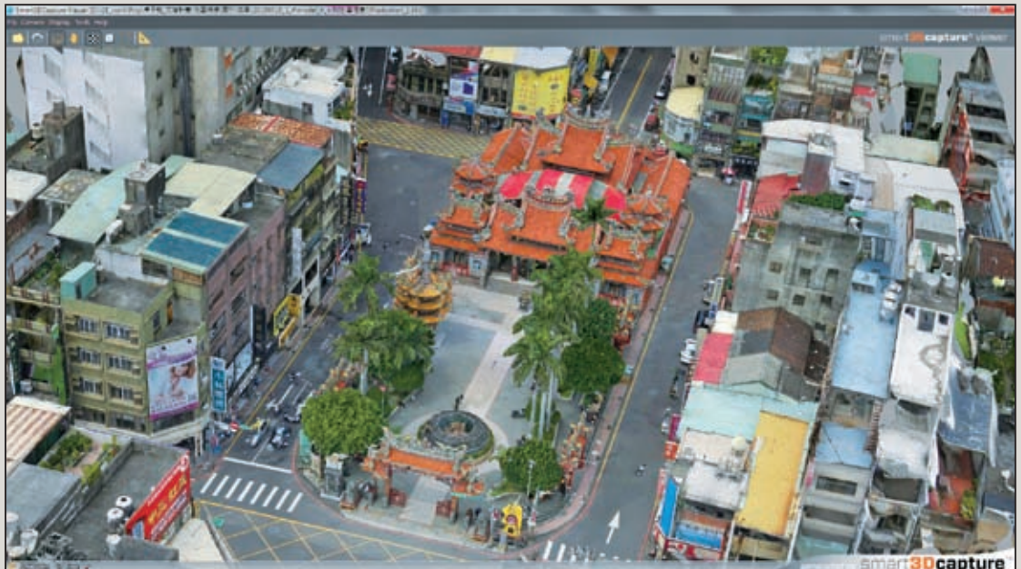
圖6 UAV空拍影像後製3D點雲影像模型(桃園景福宮)
