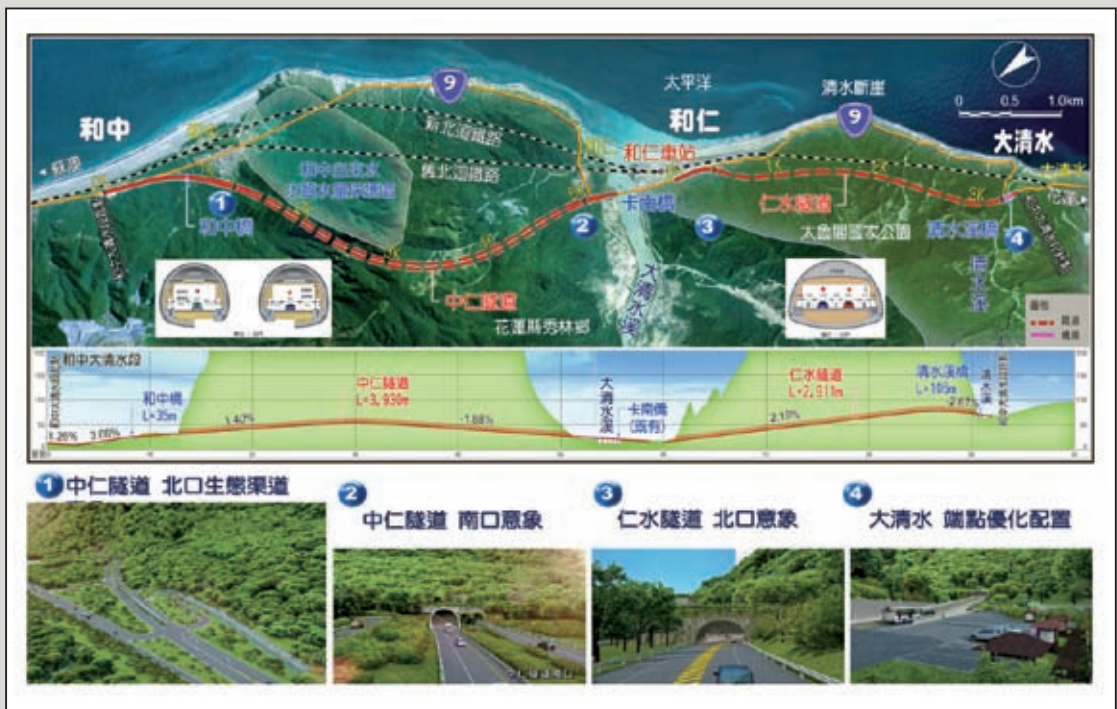
圖7 和中大清水段平縱面配置示意 (公路總局蘇花公路改善工程處及中興工程顧問公司提供)
