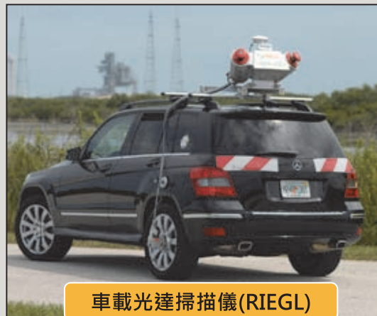
圖2 地面光達掃描系統
