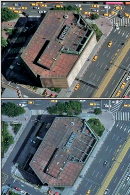
圖9 傳統正射影像(上)與真實正射影像(下)
