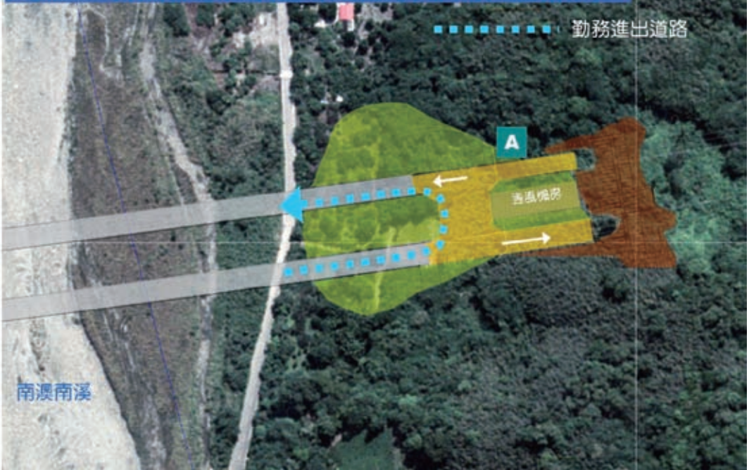
圖17 隧道口前緊急迴車道
