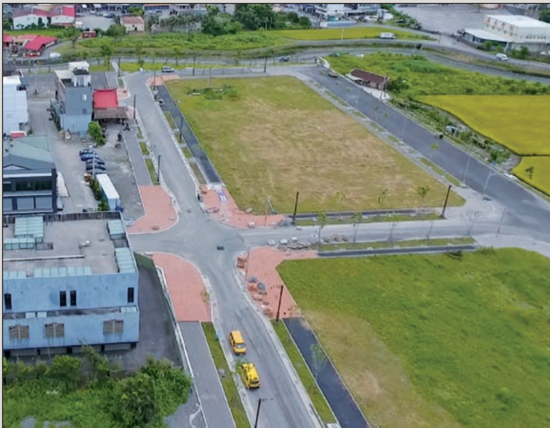
圖43 服務性道路路口束縮設計及施工現況圖
