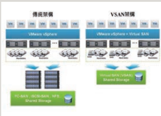
圖5 傳統架構與VSAN架構比較 資料來源[6]
