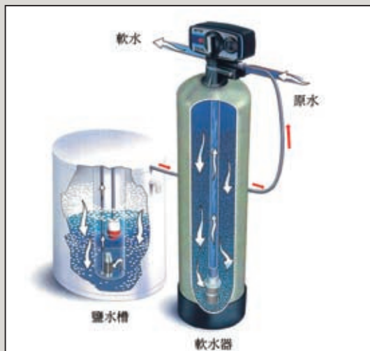
圖3 軟水器工作流程
