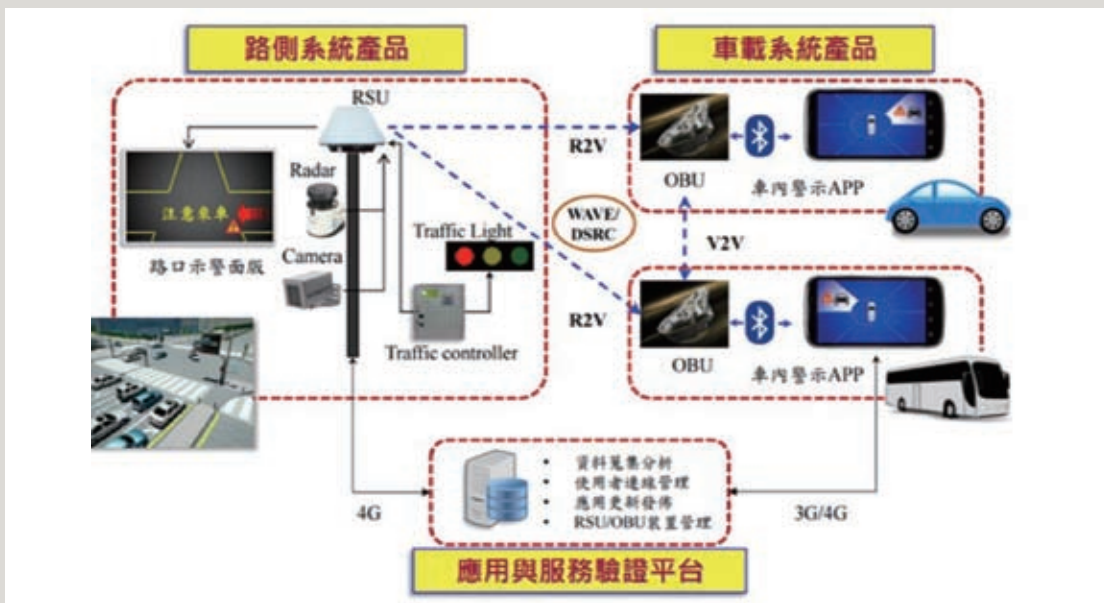
圖7 整合車聯網技術之智慧型機車防碰撞系統架構圖
