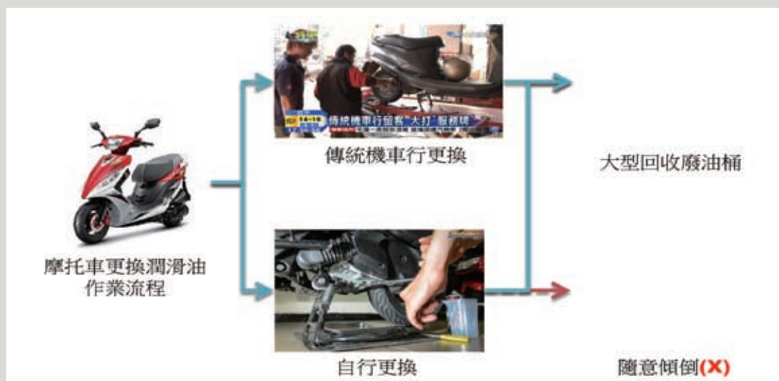
圖1 摩托車更換潤滑油流程圖
