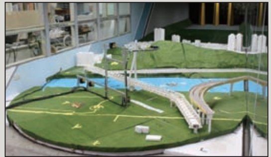
圖23 紊流邊界層流場風場試驗圖
