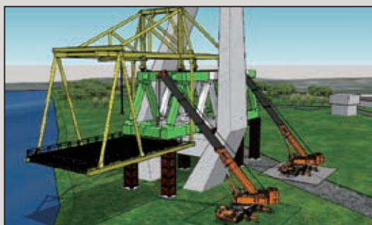
圖26 步驟2-安裝懸臂工作車
