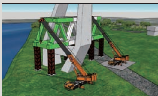
圖25 步驟1-橋塔側以輪式吊車安裝
