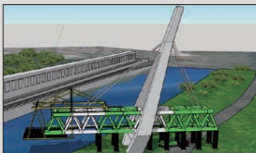
圖28 步驟4-配合推進同步拉設鋼索
