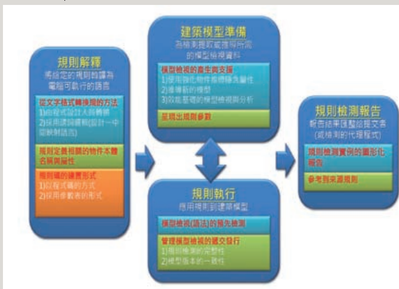
圖8 BIM模型資訊檢測架構
