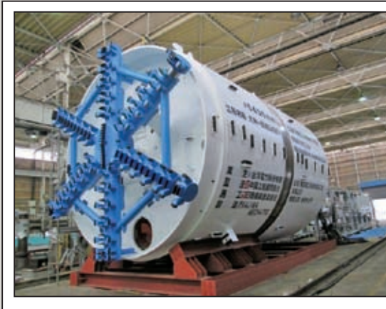
圖16 No.5潛盾機地中接合承接側及切刃刀盤正面
