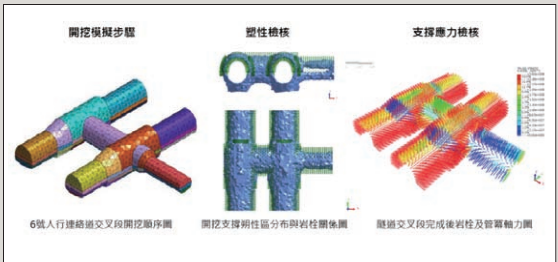
圖27 施工階段三維數值分析檢核交叉段支撐與變位
