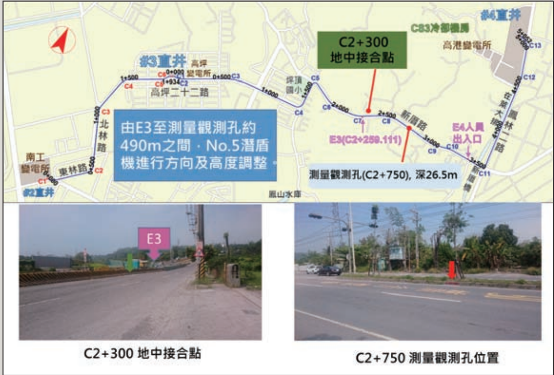
圖9 地中接合點及測量用觀測孔
