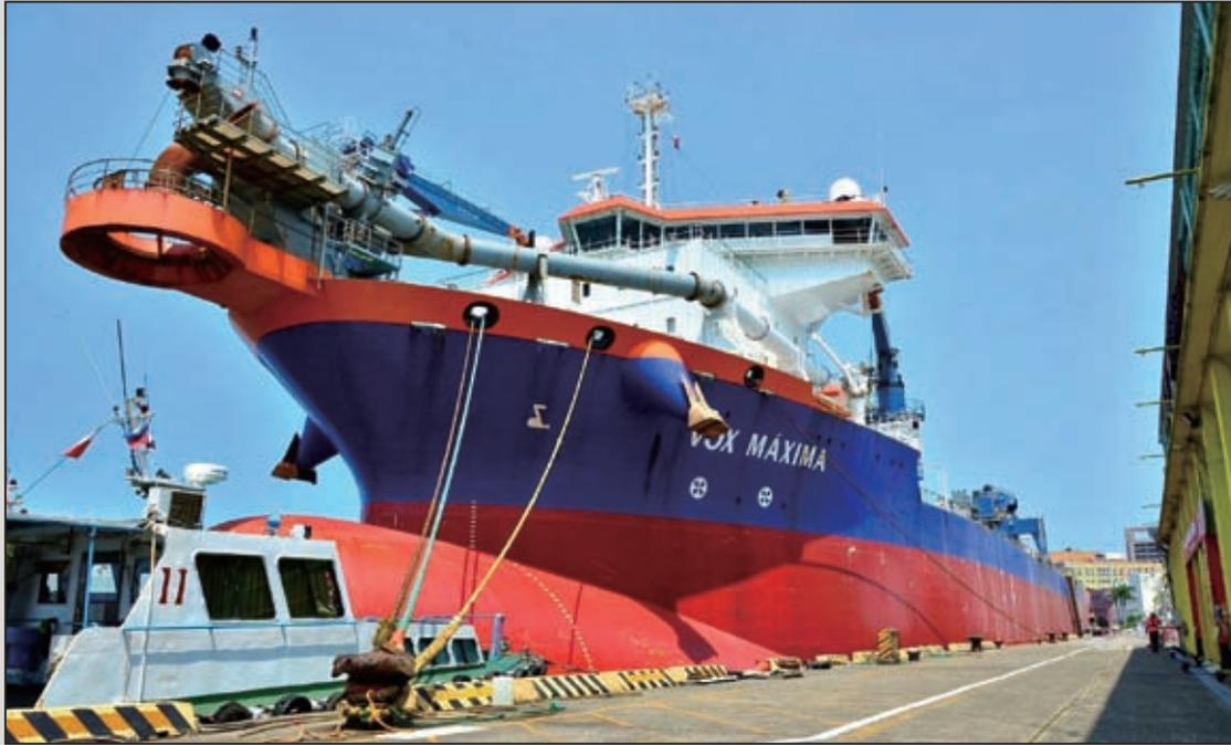
圖8 麥西瑪號(荷蘭籍)、長203m、寬31m、空重19942噸、載重55931噸、泥艙31,387m<sup>3</sup>、月量產>200萬方
