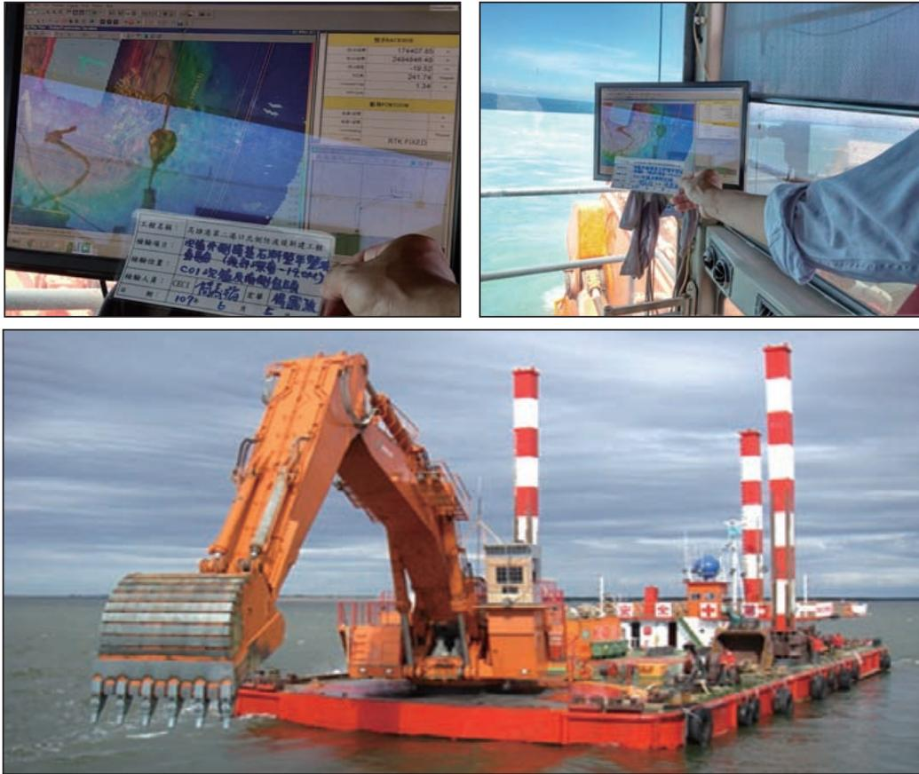
圖 13 拋石整平船設置船隻動態定位系統
