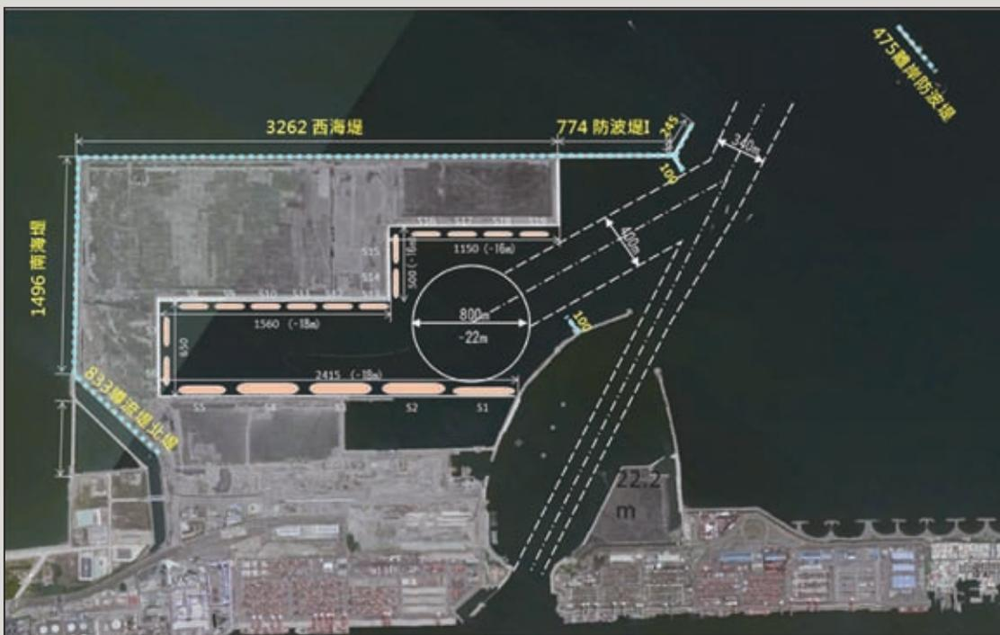
圖2 洲際貨櫃中心計畫外廓防波堤工程及離岸式防波堤工程區位示意圖
