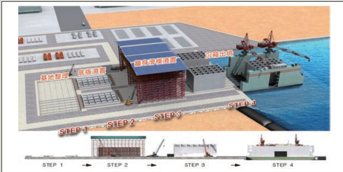
圖13 越南山陽港軌道工法沉箱施工示意圖
