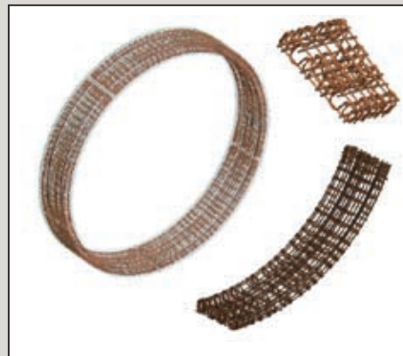
圖3 環片3D鋼筋模型
