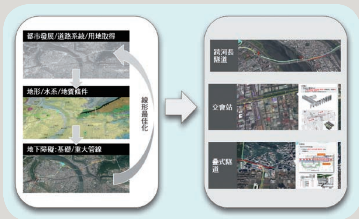
圖5 地理資訊系統輔助隧道線形設計
