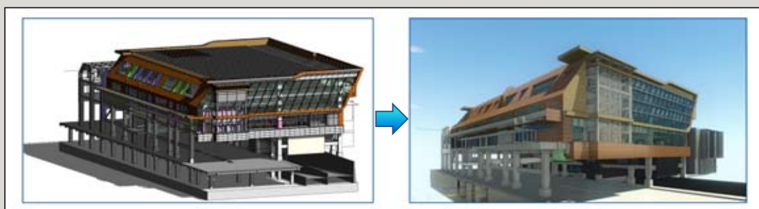
圖14 由Revit設計成果模型發展為施工模型
