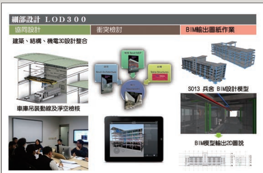
圖8 細部設計階段應用BIM進行設計整合及自動輸出設計成
