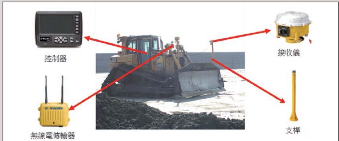
圖5 推土機配置GPS控制系統位置無缺失、合格率100%
