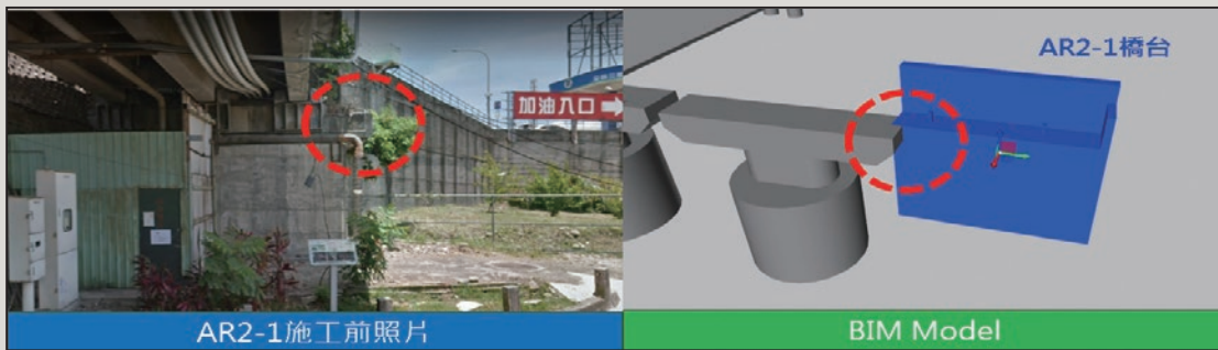
圖16 新建橋台與既有帽梁衝突檢查
