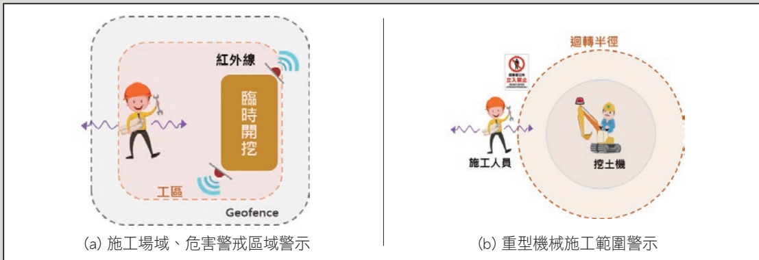
圖7 施工場域與施工機具警示功能示意圖
