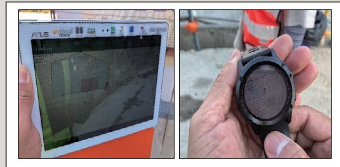
圖15 人員手錶、挖土機與主機區域監測情況
