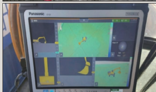
圖8 挖土機操作室螢幕顯示各部位動作高程
