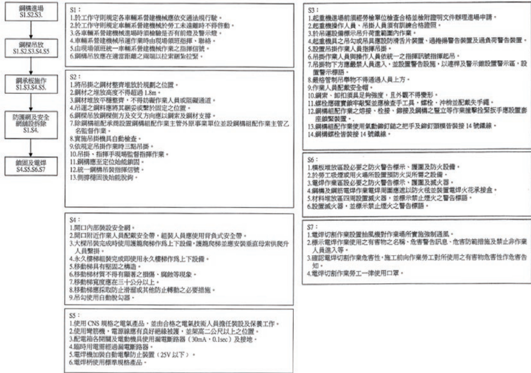
圖4 鋼梁吊裝作業流程及各階段安全衛生設施規劃例示
