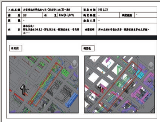
圖11 排水管衝突碰撞檢查並提出解決方案
