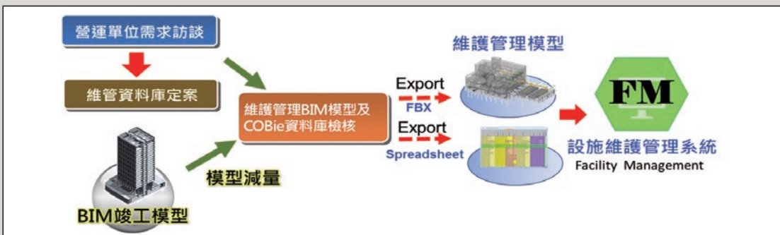
圖12 維護管理資訊系統前置作業執行流程圖
