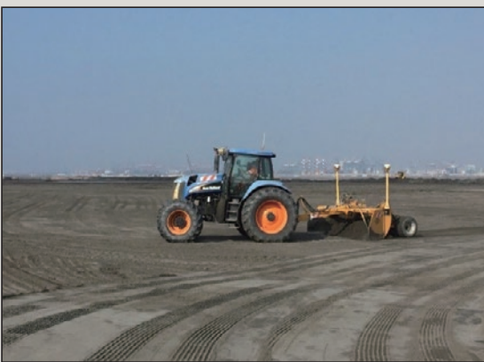
圖3 機具整平作業中自主控制成果
