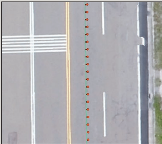
圖21 圖資車道中線與實車行駛軌跡
