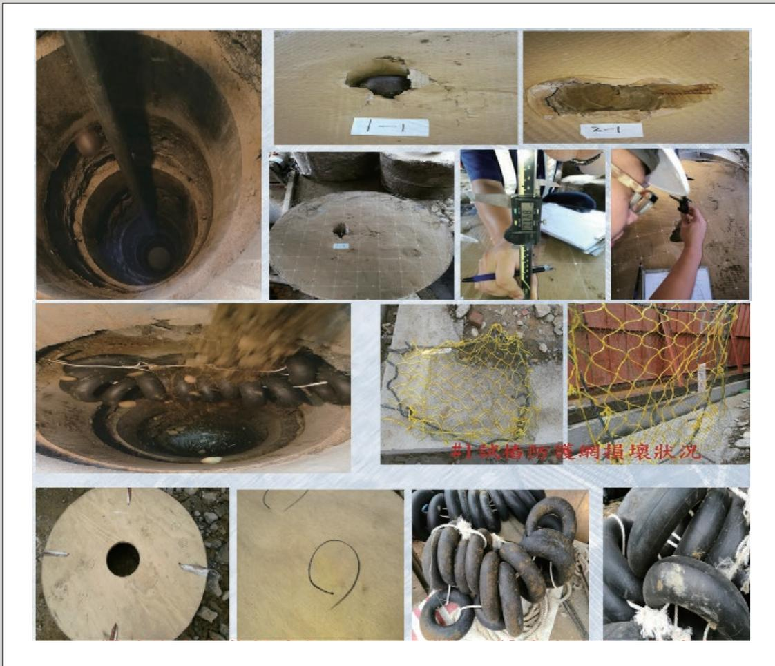
圖12 落球測試(上)與傾卸測試(下)
