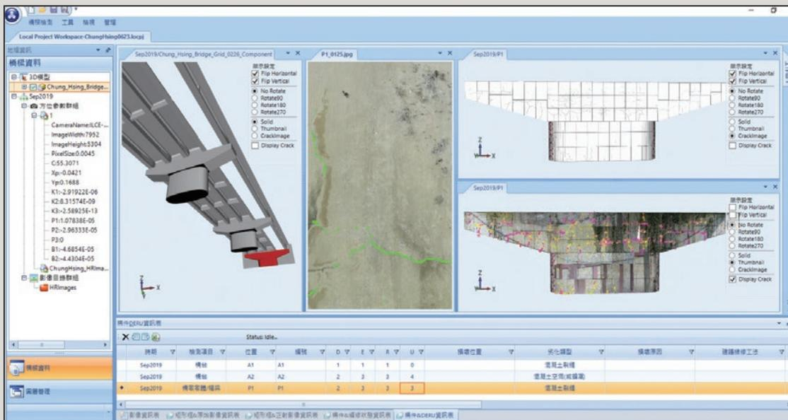
圖4 LOC6D橋梁檢測系統
