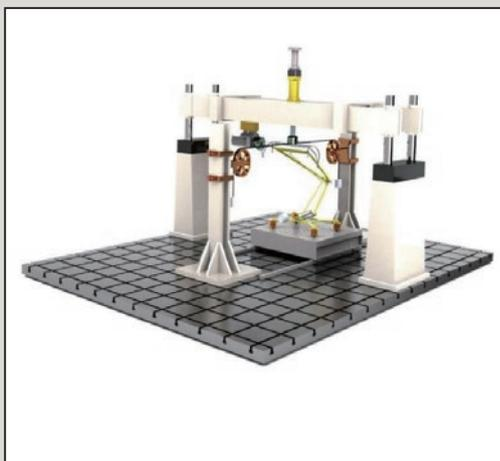
圖15 集電弓靜力與負載測試設備
