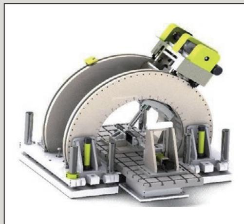
圖16 軌道複合基鈑負載與疲勞測試設備
