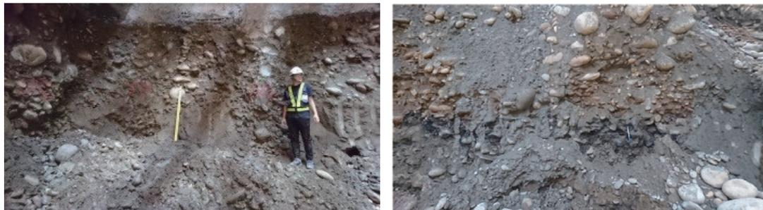
圖14 G9-1站開挖出露之卵礫石層中夾細砂層
