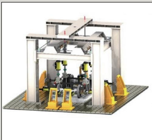
圖13 轉向架負載測試設備
