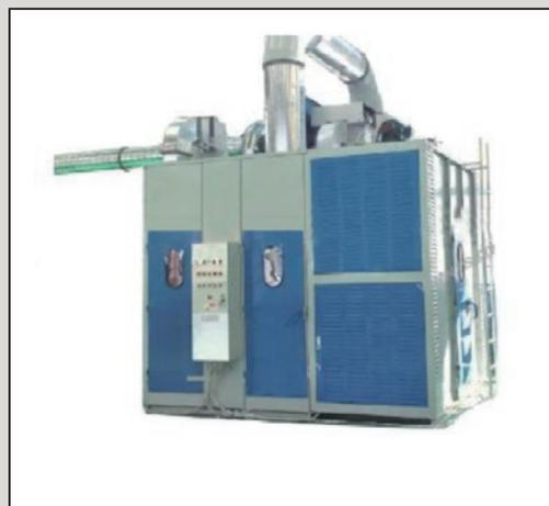
圖18 防塵防護等級1-6測試設備
