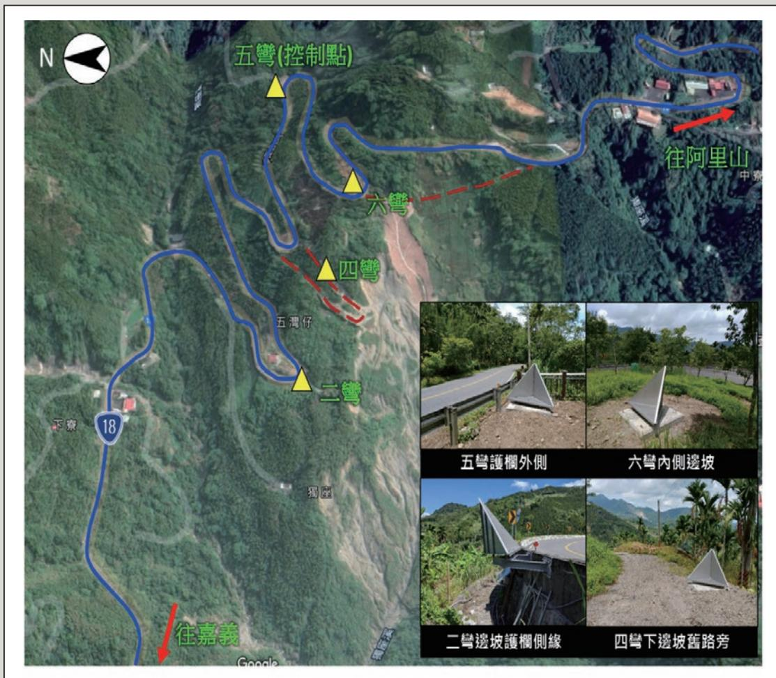
圖20 五彎仔角反射器安裝位置示意圖(底圖參考google map繪製)
