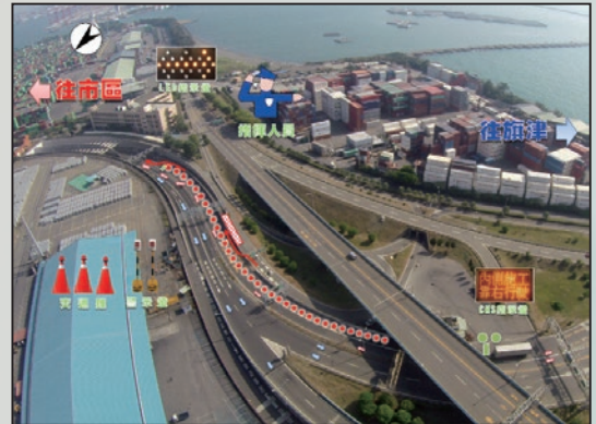
圖22 封閉南孔機車道交維配置(中興端)
