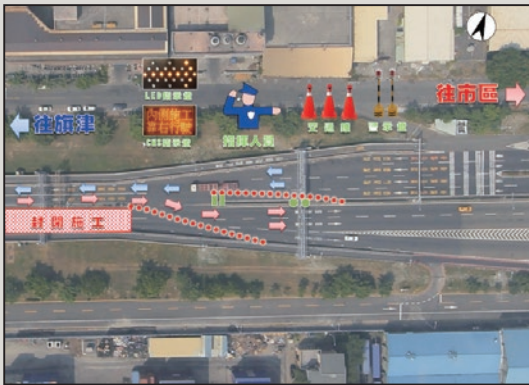
圖18 封閉南孔快車道交維配置(前鎮端)
