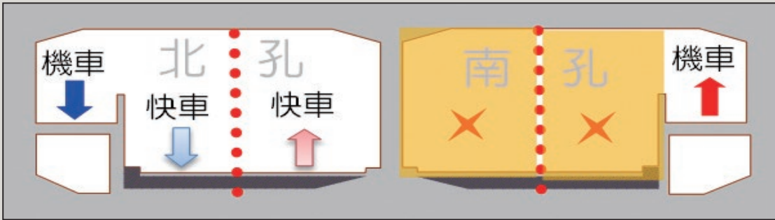
圖17 封閉單孔快車道之車道配置圖
