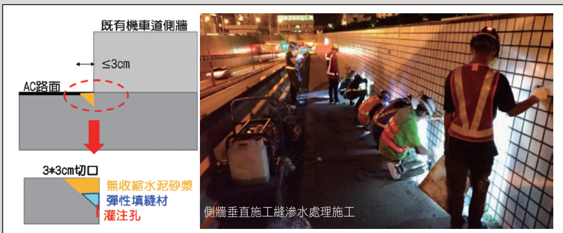
圖5 側壁垂直施工縫修補示意圖
