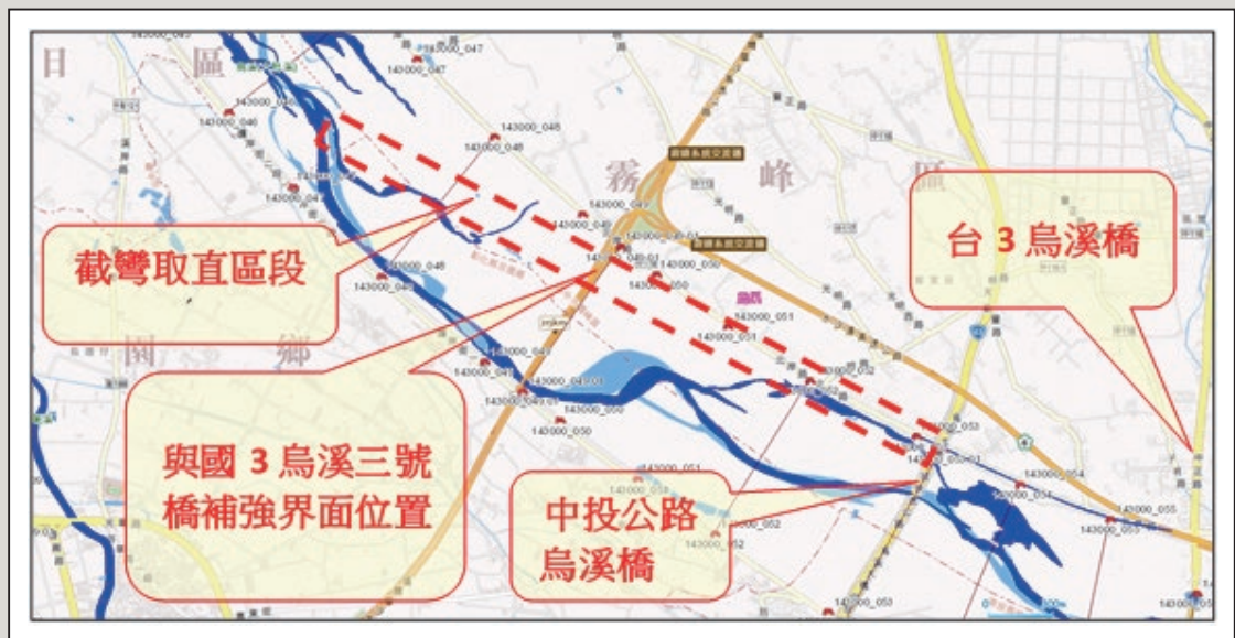
圖23 烏溪三號橋河道整治示意圖
