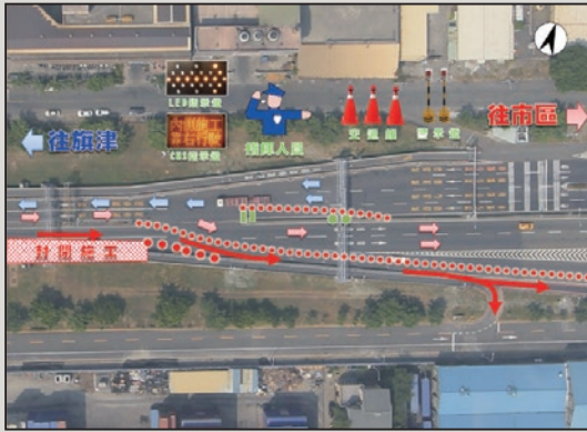
圖21 封閉南孔機車道交維配置(前鎮端)
