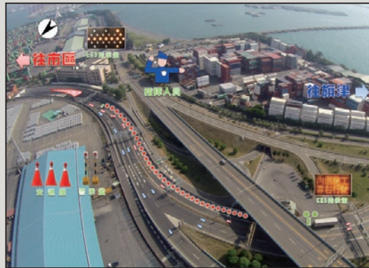
圖19 封閉南孔快車道交維配置(中興端)
