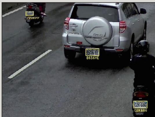
圖11 可同時辨識汽車、機車等不同車型之車牌號碼 [8]
