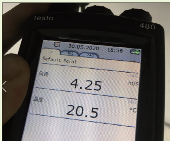
圖14 Testo 480風速量測
