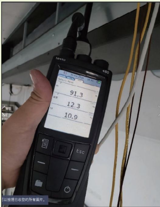
圖22 Testo 480溫度值量測
