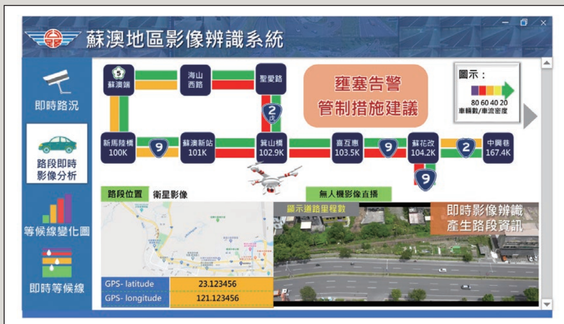
圖21 無人機路段車流分析儀錶板示意圖
