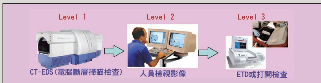
圖7 三級安檢操作流程
