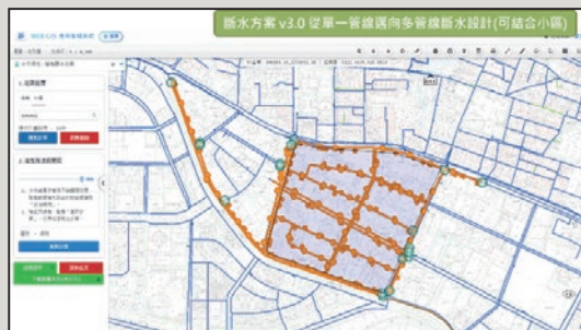
圖9 多管同時進行汰換時顯示邊界閥
