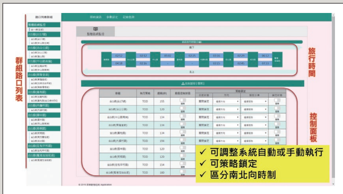
圖15 智慧化號誌系統監控畫面(2)
