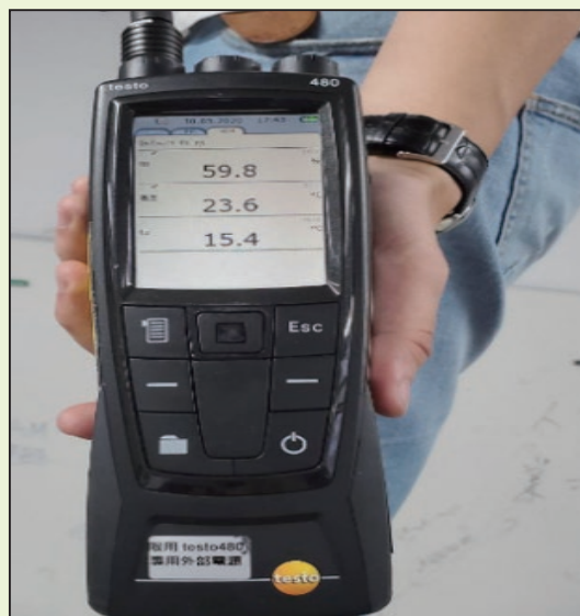
圖19 Testo 480溫度和相對濕度量測
