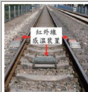
圖5 車輪裂縫偵測原理
