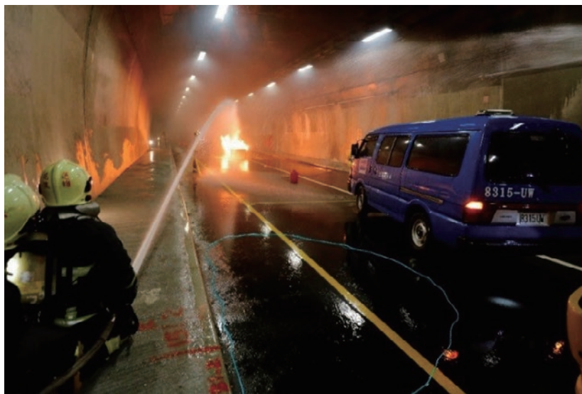
圖16 全尺度煙控測試
