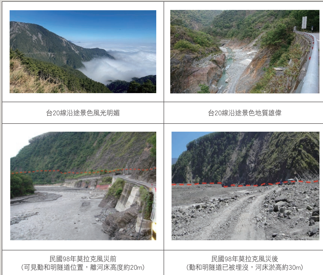
圖2 台20線現況及莫拉克災損圖
