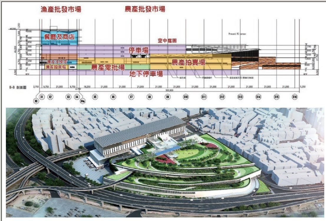
圖11 改建樓層分佈圖及透視圖，西側較高主為漁產棟，東側屋頂花園下方為農產棟
