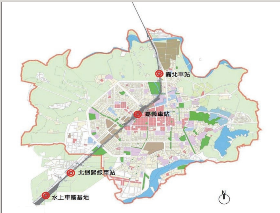
圖7 鐵路高架化工程北起牛稠溪以北(臺鐵西部幹線里程K291+737)，南至嘉義縣水上鄉水頭村(臺鐵西部幹線里程K302+637)，全長10.9公里。
