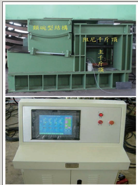
圖5 頂昇滑移設備
