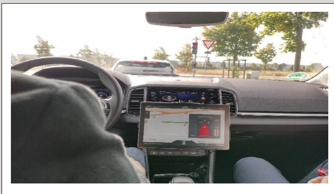
圖24 體驗V2X用例：RSU 將前方號誌燈號狀態傳送到 OBU
