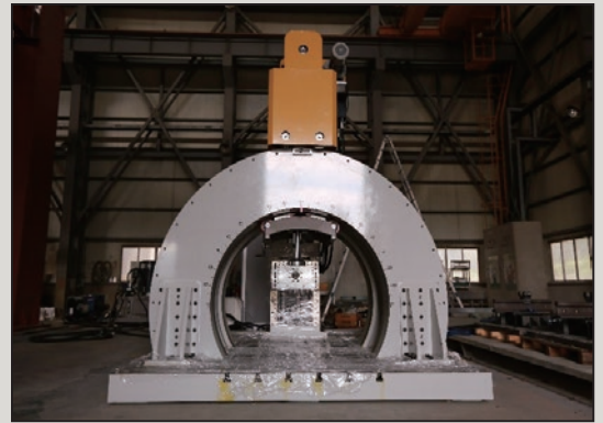
圖11 軌道複合基鈹負載與疲勞測試設備
