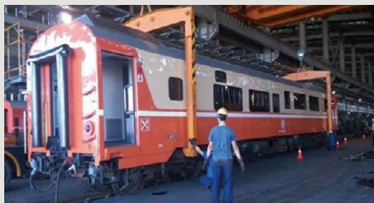
圖11 傳統設備／架空式移動起重機搭配門型吊架，配合工作人員進行車廂吊運工作，一次吊運一節車廂。
