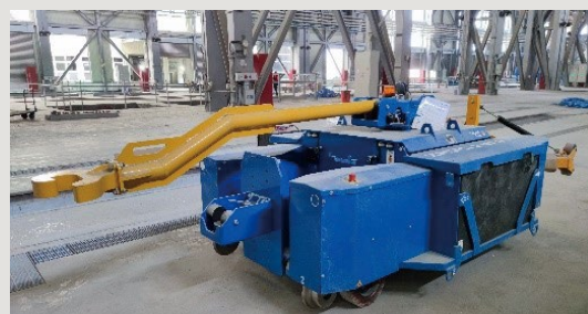
圖6 創新設備／以轉向架牽引車沿軌道牽引，安全性佳
