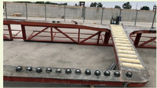
圖16 橡膠材質剪力樺模具
