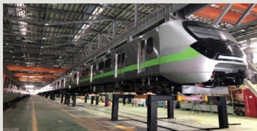
圖12 創新設備／地下式頂升設備(臺鐵第一套設備)，設備同步升降，一次頂升整列車體。
