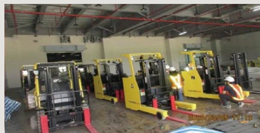
圖14 創新設備／改為電動堆高機，達到免除空氣污染、避免高速衝撞、降低噪音影響。
