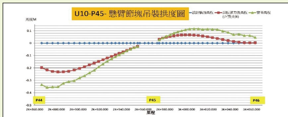
圖33 P45節塊吊裝拱度圖
