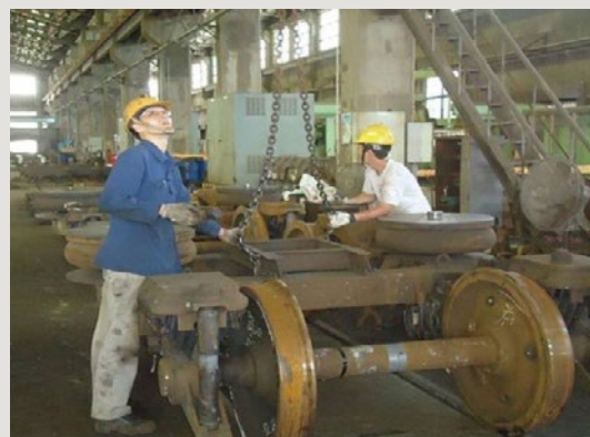
圖5 傳統設備／以天車輔以人力吊運，風險高
