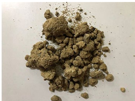
圖8 基樁出渣水色黃濁(高度及完全風化岩盤)
