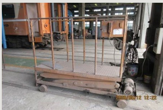
圖7 傳統設備／軌道型電動高架工作檯車，方便進行1.5公尺至3公尺高度工作之工作台車。
