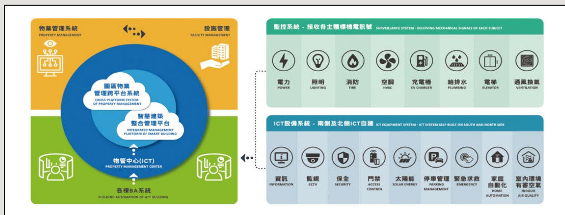
圖8 中央監控系統整合管理平台包含18項子系統
