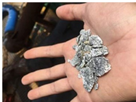
圖9 基樁出渣水色清澈(中、輕度風化岩盤)
