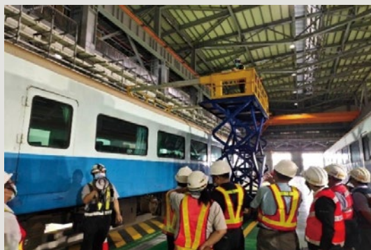
圖8 創新設備／軌道型電動高架工作檯車，方便進行1.5公尺至3公尺高度工作之工作台車。
