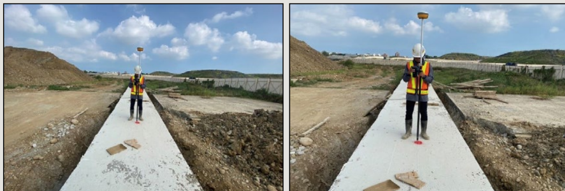
圖13 3D管線實測點位照片範例（左：管線測點遠照、右：管線測點近照）
