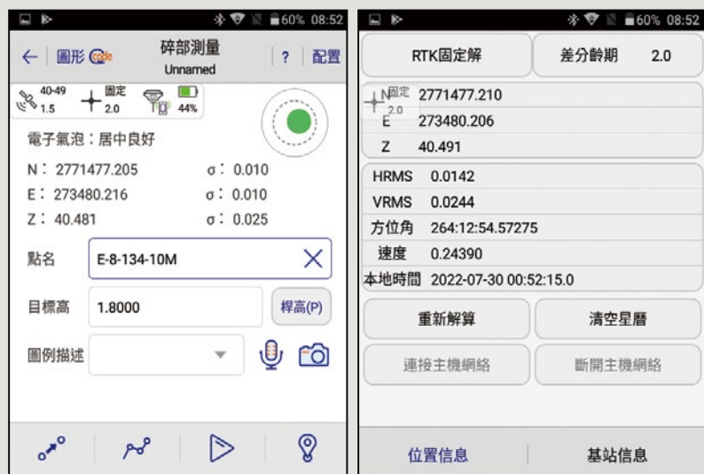
圖14 3D管線實測點位照片範例(GNSS測量儀器畫面截圖)
