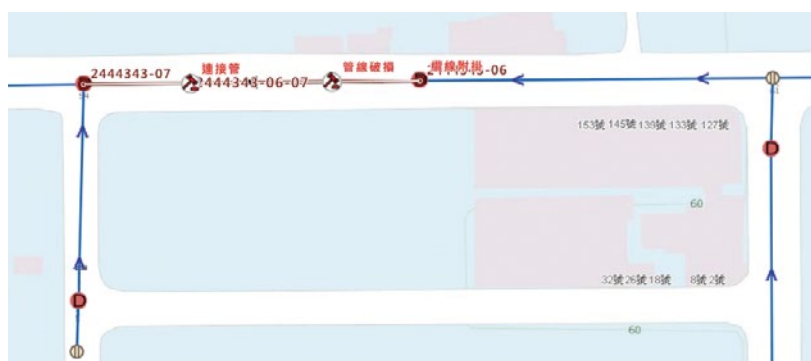
圖17 下水道管網分布及巡檢發現的異常位置
