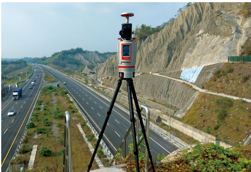
圖1 RIEGL VZ400i地面光達掃描儀
