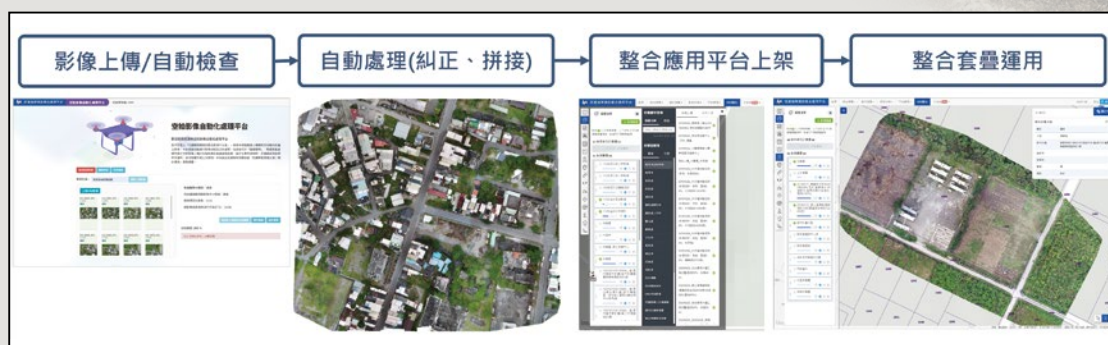
圖16 花蓮自動化空拍影像正射拼接處理平台作業流程
