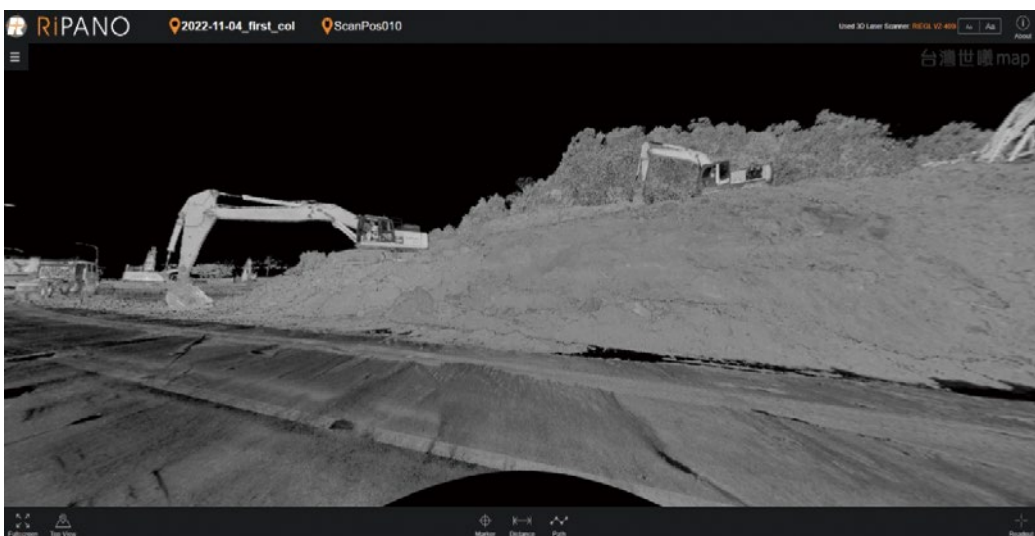
圖31 國道1號汐止交流道邊坡崩塌光達點雲資料
