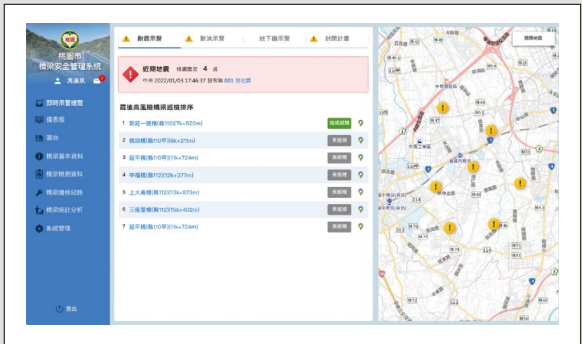
圖9 震後高風險橋梁巡檢排序圖
