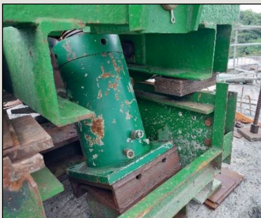
圖17 工作車鋼墊塊變形
