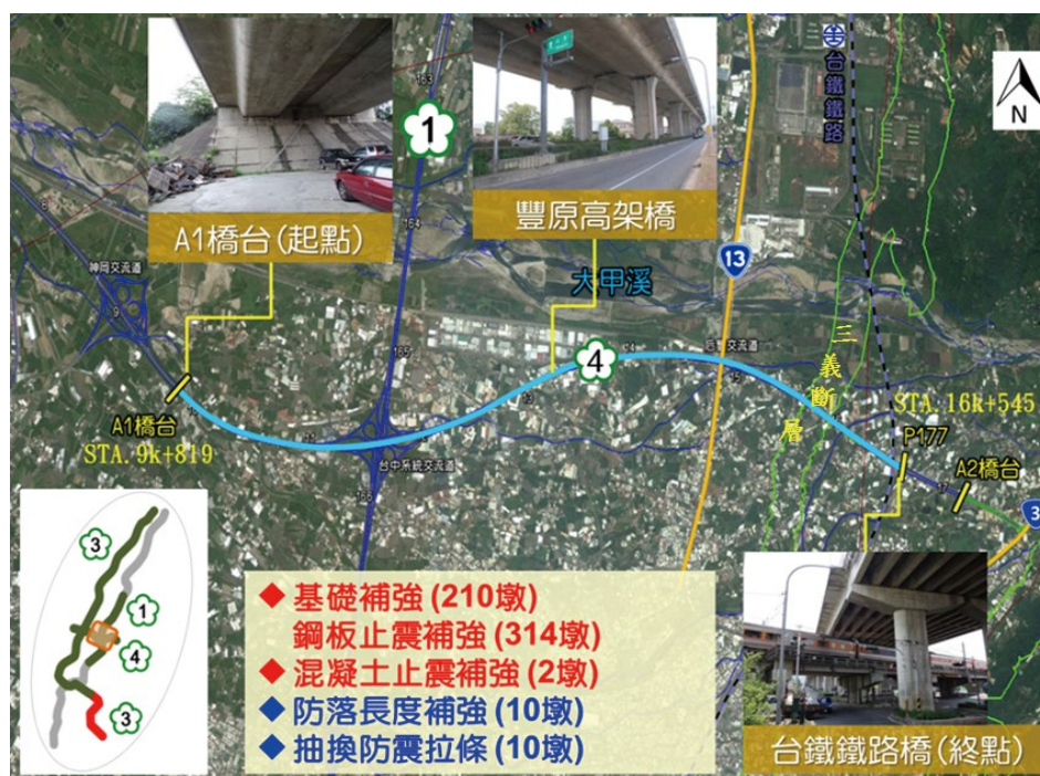
圖22 第M41標近斷層300公尺範圍橋梁
