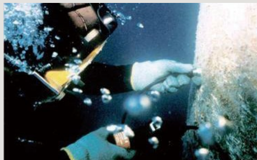
圖4 第三級檢測超音波厚度檢測[4]
