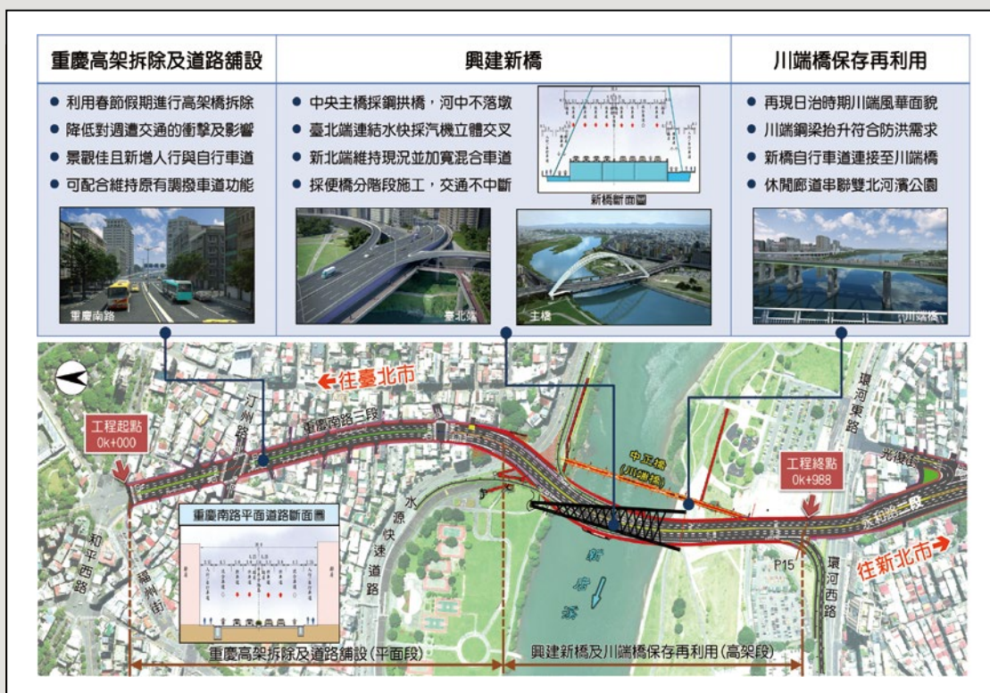
圖3 中正橋改建工程工區及工項示意圖
