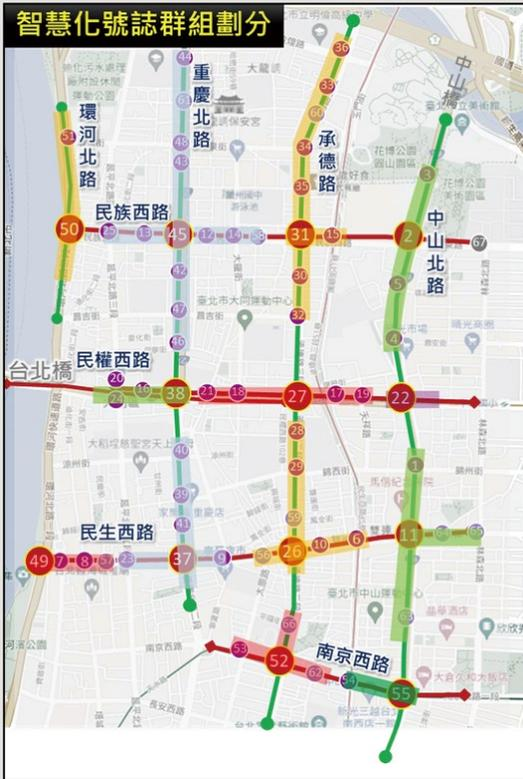
圖8 動態號誌控制群組劃分示意圖
