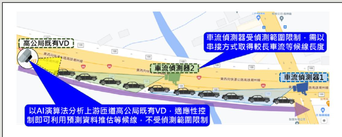
圖2 以台88既有VD進行預測並取代等候線車流偵測器串接
