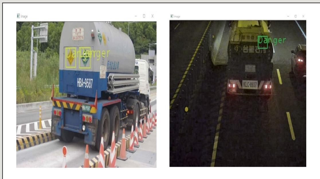
圖10 正確辨識危險品運輸圖示之車輛
