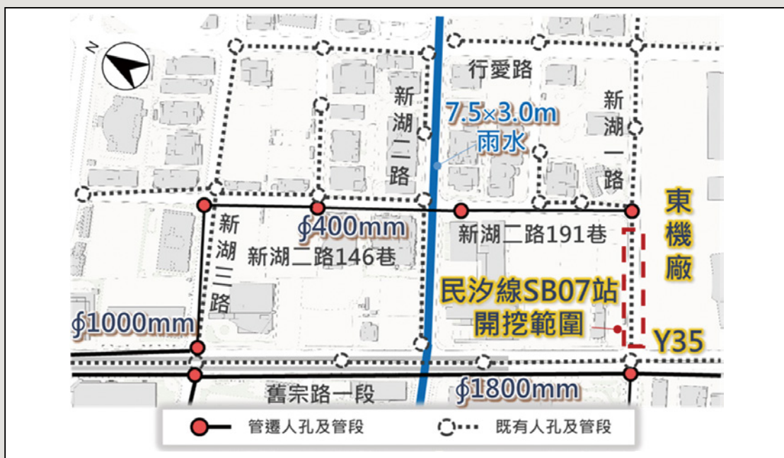
圖8 新湖一路 \phi 400\text{mm} 污水管線遷建銜接示意圖
