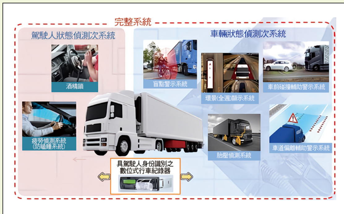
圖1 交通部「大型車輛裝設主動預警輔助系統」計畫之整合系統分類及其整合項目
