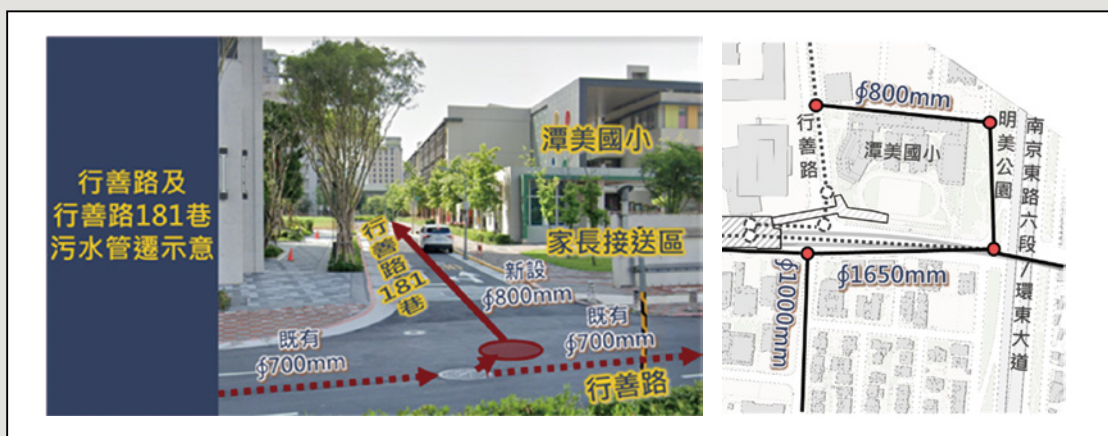
圖7 行善路 \phi 700\text{mm} 污水管線遷移銜接示意圖
