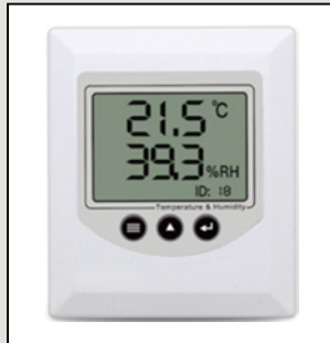
圖14 室內二合一顯示型環境感測器(溫/溼) [7]
