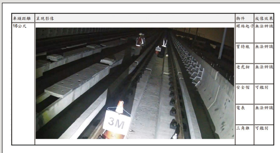
圖8 使用更高規格攝影機夜間測試(模擬車燈)結果
