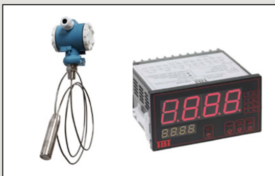
圖11 壓力式液位器(左) [4] 與可程式數位顯示控制器(右) [5]
