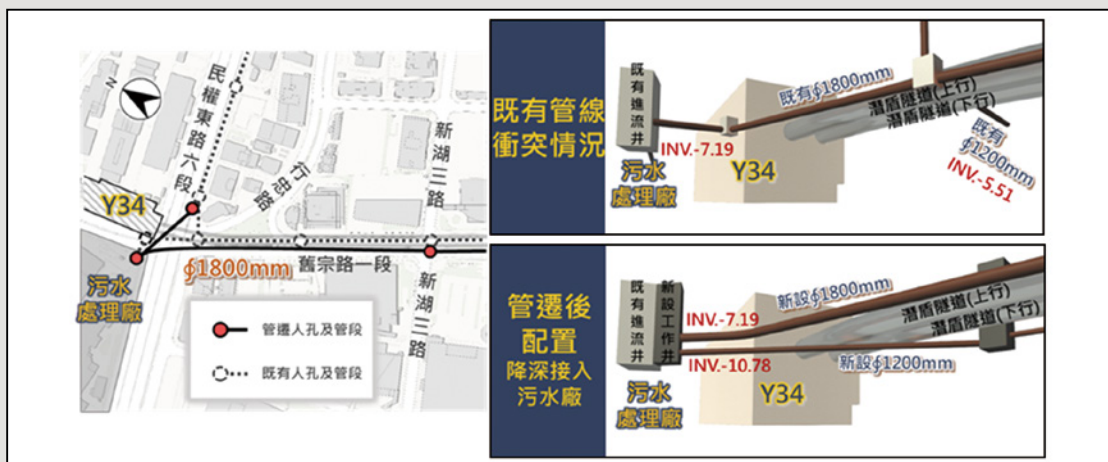
圖6 民權東路污水次幹管(FC)遷移銜接示意圖
