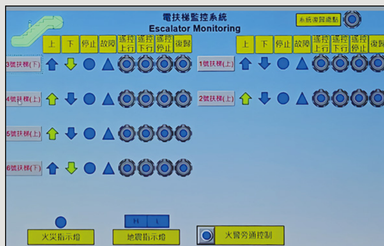
圖18 電(扶)梯監控系統介面
