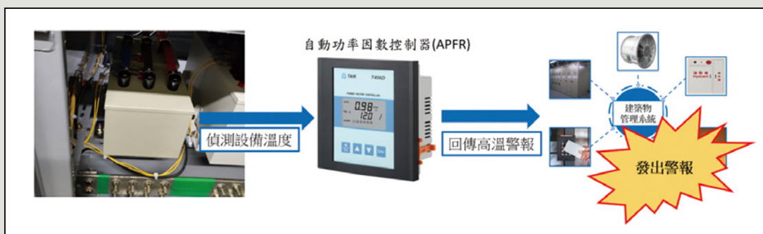
圖9 APFR警報流程示意圖
