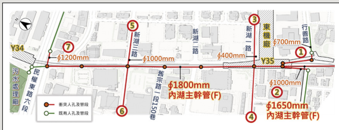
圖2 Y34~Y35~Y36站間既有污水管線平面圖
