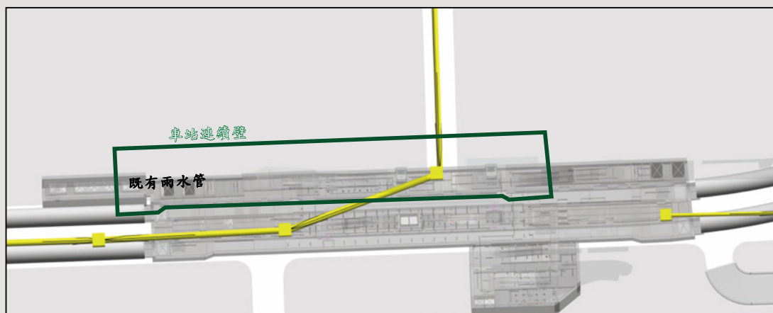
圖8 臺北捷運東環段DF119標管線與車站平面位置衝突
