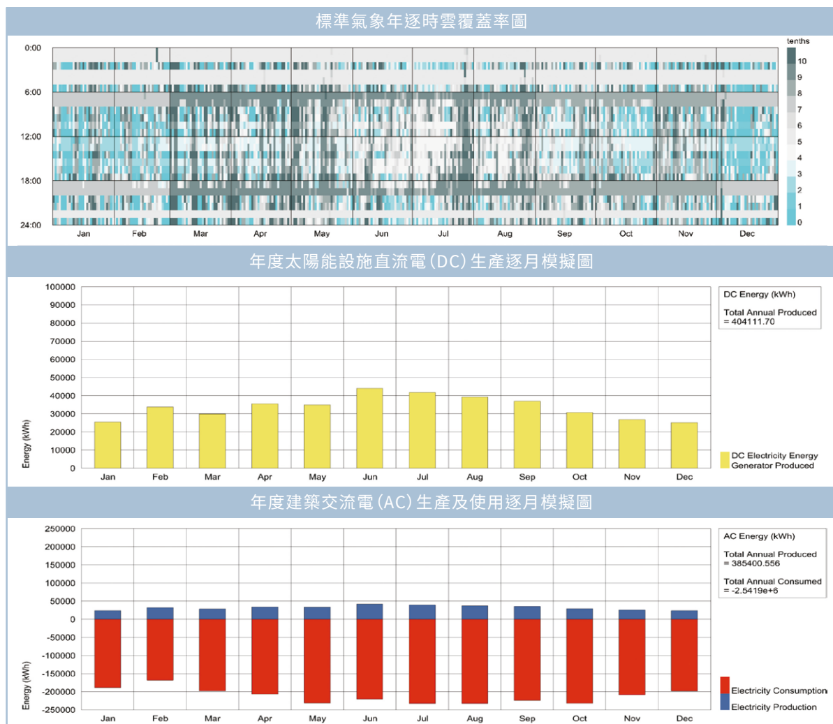
圖 11 太陽能設施逐月發電級建築使用電量模擬
