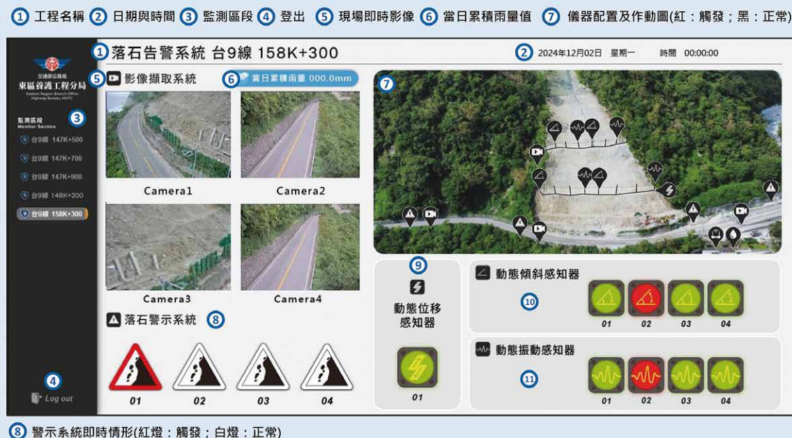
落石告警系統圖形化雲端監控
