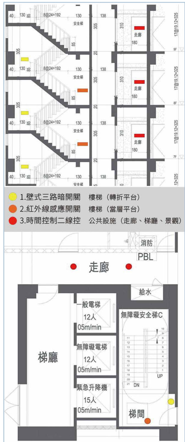
圖 10 燈光節能系統設置示意圖
