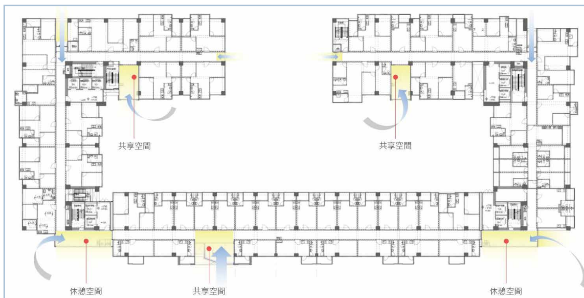
圖 9 居住樓層設計採光通風低耗能
