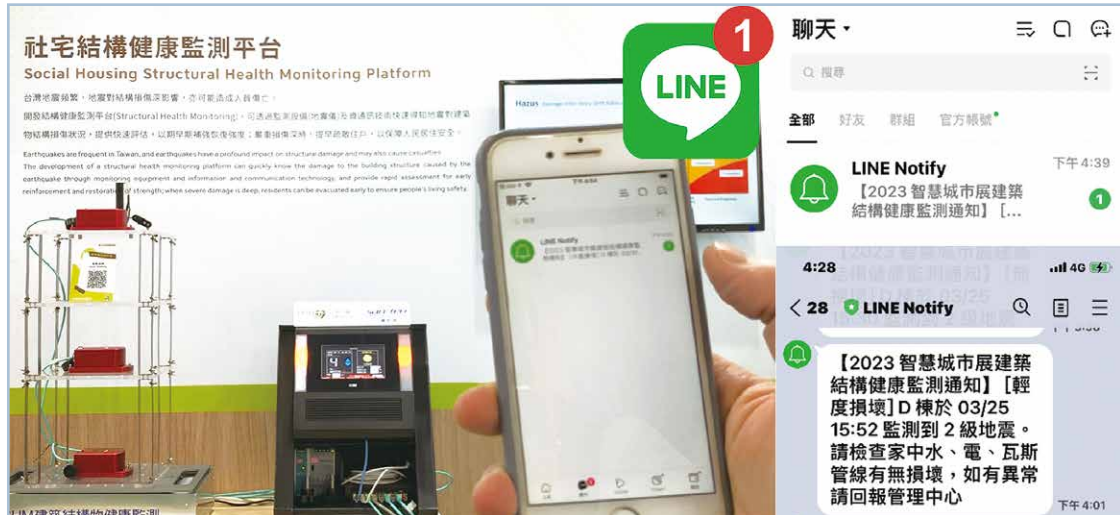
圖 5 模擬地震發生後即時透過 LINE 通知評估結果
