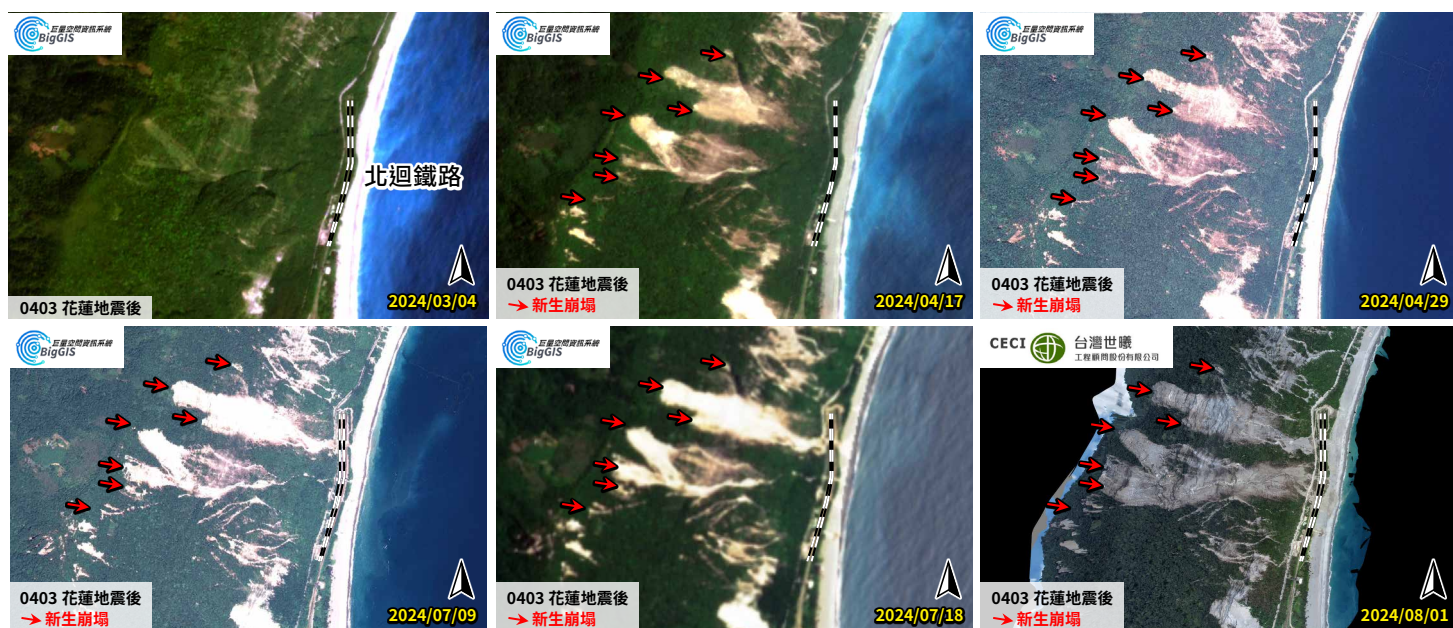
圖 13 地震前後 K56 路段上邊坡之變化情形 (改繪自農業部農村發展及水土保持署)
