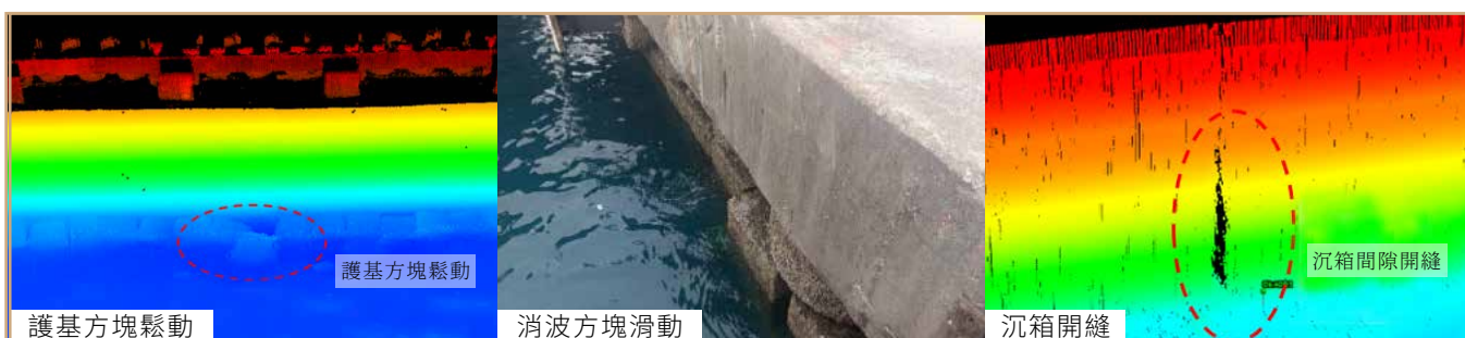
圖 3 水下，高密度水深測量。
