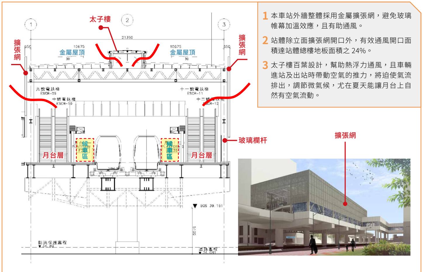
圖 4 高架車站自然通風設計示意圖
