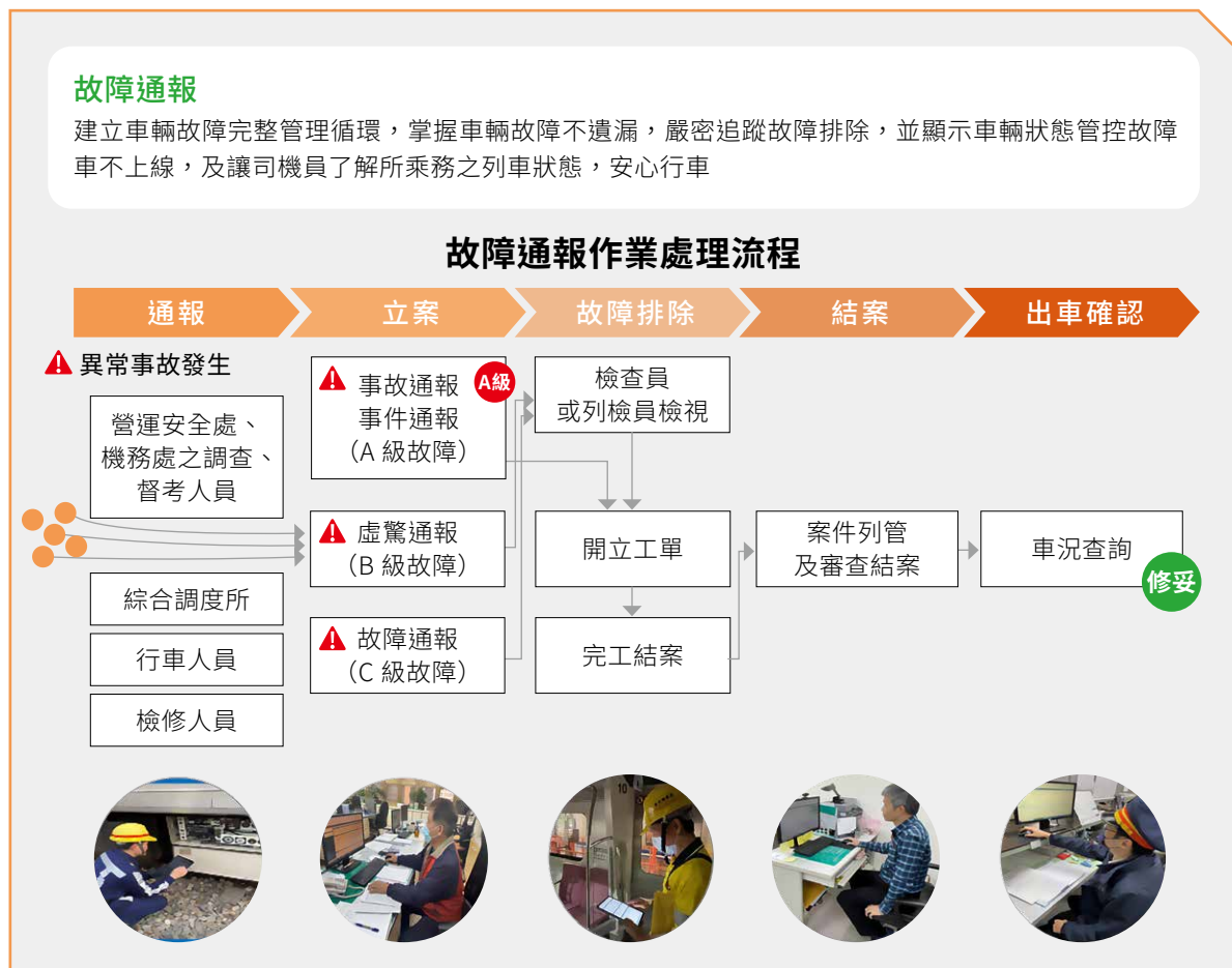
圖 17 故障通報作業處理流程
