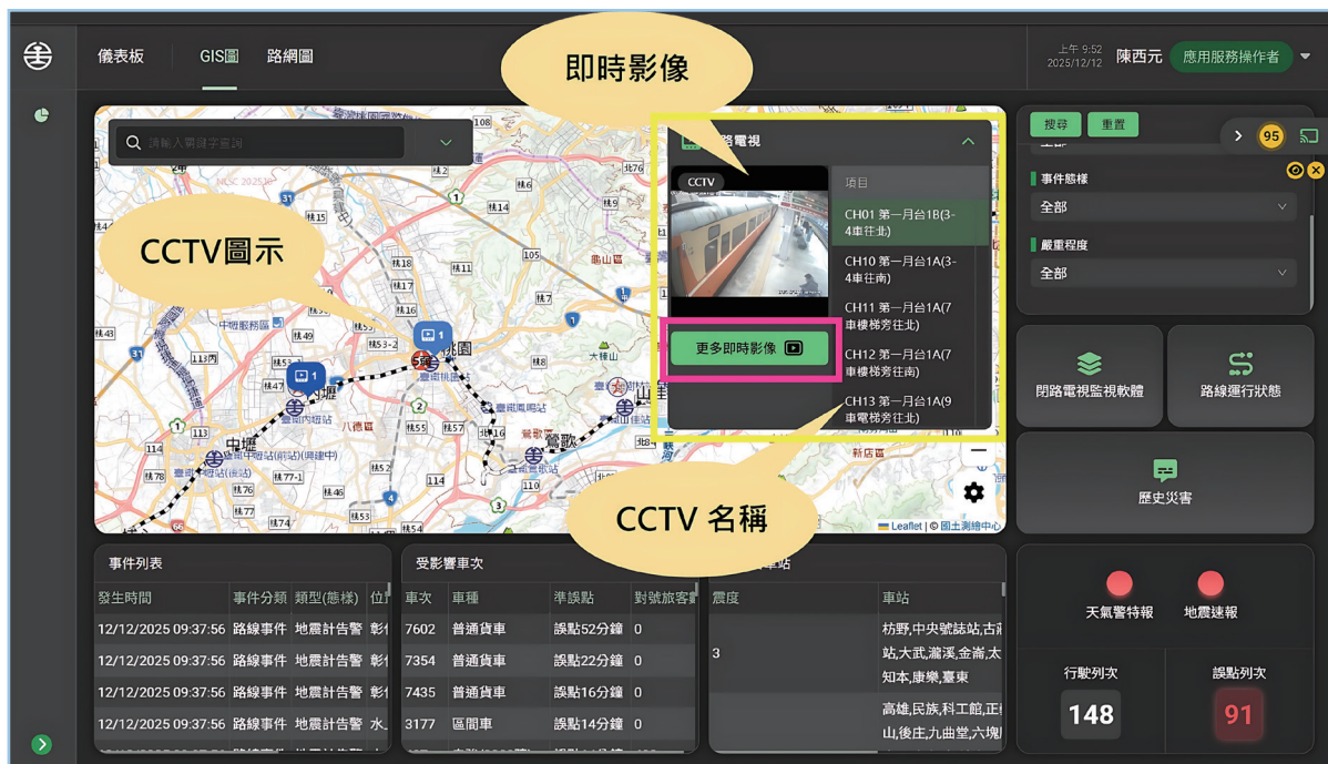
圖 7 CCTV 視覺化整合監視調閱
