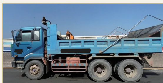
圖 6 載重試驗卡車－20 噸
