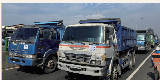
圖 5 橋梁現地載重試驗
